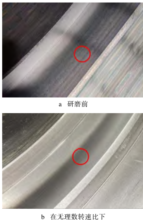
图 8 研磨前后表面形貌的变化
